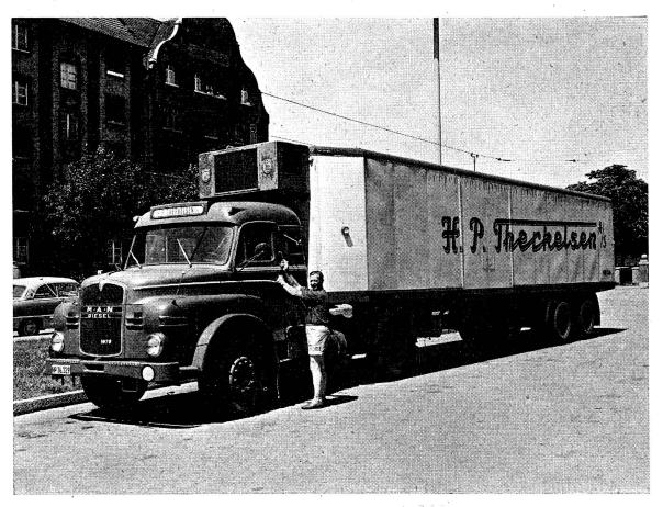
Abbildung 1 Kühlcamion, wie sie heute im internationalen Transport von Fleisch und andern leicht verderblichen Lebensmitteln eingesetzt werden. Über der Führerkabine, unabhängig vom Lastwagenmotor, das Kühlaggregat.
