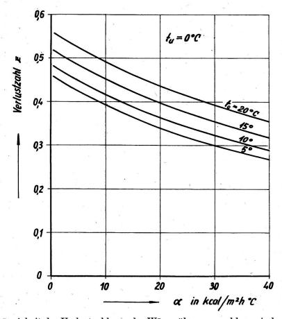
Abb. 4 Abhängigkeit der Verlustzahl von der Wärmeübergangszahl  $\alpha$  zwischen Fleischoberfläche und kühlender Luft bei einer Temperatur der letzteren von  $t_u=0\,^\circ$ C und verschiedenen Werten der Oberflächentemperatur  $t_0$ .
