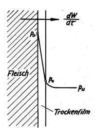
Abb. 1 Abnahme des Wasserdampf-Teildruckes über der Fleisch-Oberfläche.
