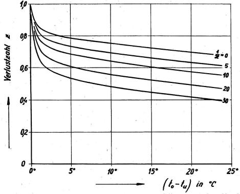
Abb. 3 Abhängigkeit der Verlustzahl von der Temperaturdifferenz zwischen Oberfläche und Kühlluft für verschiedene Werte des Dampfdurchlaßwiderstandes des Oberflächenfilmes. Es bedeuten:  $t_0 = \text{Oberflächentemperatur}, t_u = \text{Umgebungstemperatur}, x = \text{Wasserdampf-Durchgangszahl}$  des Trockenfilmes in kg/mh² Torr.
