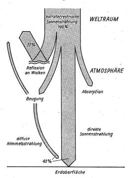
Abb. 1. Einstrahlungsverhältnisse auf der Nordhalbkugel unter mittleren atmosphärischen Bedingungen (nach Geiger, in Seybold und Woltereck, 1952).
