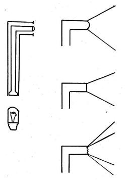
Abgeschmolzene Kugelendfläche. Divergenzwinkel ist abhängig vom Kugelradius (je kleiner r, desto größer der Winkel).
