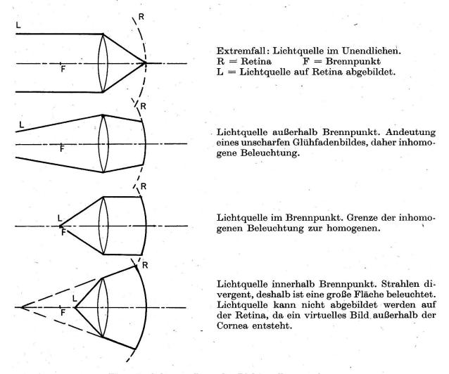
Figur 1. Schema: Lage der Lichtquelle zum Auge.
