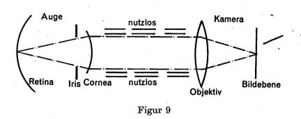
Wesentlich ist, daß hierbei nicht die relative Öffnung berücksichtigt werden kann, sondern daß der Querschnitt des Strahlenbündels die Leuchtdichte auf dem Film bedingt. Folglich ist die Leuchtdichte proportional dem absoluten Querschnitt der Pupillenöffnung, abzüglich der Reflexblendenfläche.
