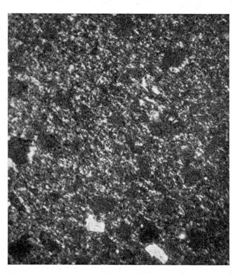
Abb. 2. Gipsprobe 5 Tage in gesättigter NaCl-Lösung aufbewahrt. Große, gleichmäßig verteilte Poren. Typ eines festen Schaumes.
