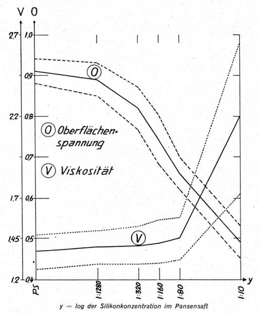
Fig. 8. Oberflächenspannung und Viskosität von Silikon-Pansensaft.
