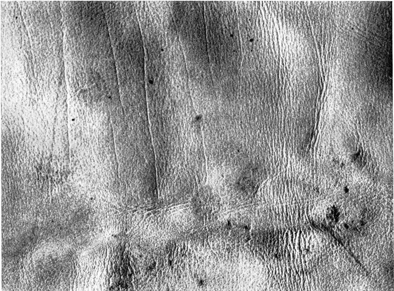
Fig. 8. Lésions sur un cuir tanné de veau, provoquées naturellement par les malhophages d'une part et d'autre part par le poussoir électrique (Brûlures punctiformes).
