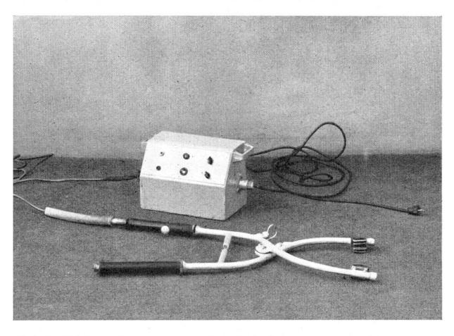
Abb. 1. Elektroschock-Apparat für Schlachttiere (von rechts gesehen) mit Betäubungszange (rechteckige Elektroden).
