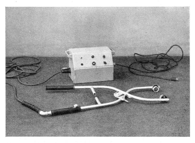
Abb. 2. Elektroschock-Apparat für Schlachttiere (von links gesehen) mit Betäubungszange (runde Elektroden).
