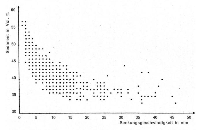
Fig. 4. Verhältniskurve zwischen Sediment und Senkungsgeschwindigkeit nach 15 Minuten.
