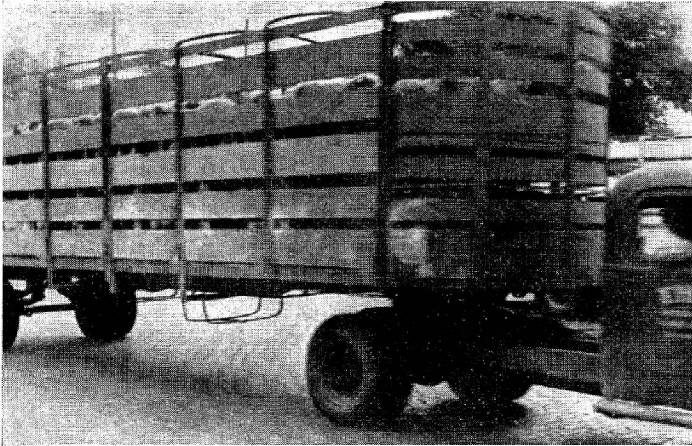
Abb. 15. Zweistöckiger Auto-Sattelschlepper für Schaftransporte.
