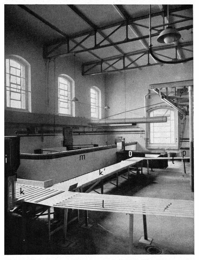
Fig. 2. Schweineschlachtanlage mit Enthaarungsmaschine (ganz links, nur teilweise sichtbar), Transport- und Enthaarungstischen. Dahinter die Reserve- und die Einzelschlachtanlage.
