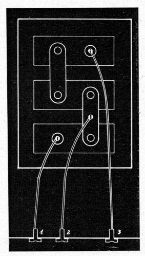
Abb. 1. Schema des Anschlusses der Automobilbatterie.
