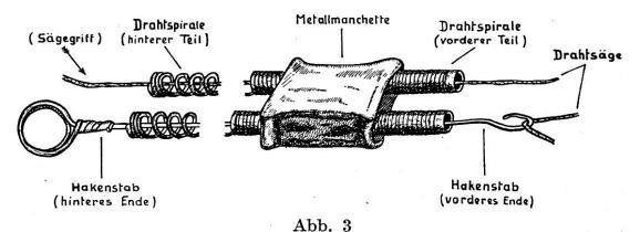
Das Einziehen der Drahtsäge mit dem Hakenstab.
