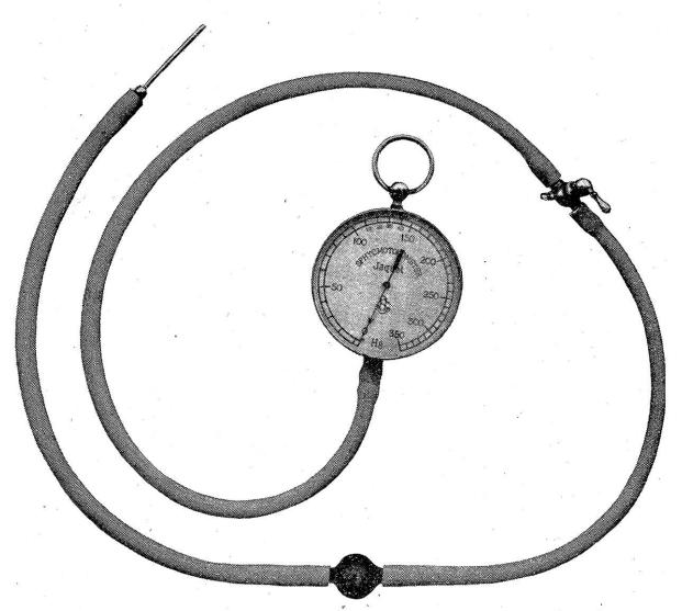
Fig. 1. Sphygmotonometer zur Bestimmung des Milchdrucks.
