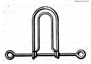
Der vom Sanitätsgeschäft Hausmann A.-G. in St. Gallen hergestellte Apparat ist höchst einfach und besteht aus einem basalen, runden Eisenstab und zwei zungenförmigen Schlingen, die mit dem basalen Teile beweglich verbunden sind; an letzterem befinden sich noch zwei Ösen zum Befestigen einer Schnur, die hinter die Hörner und Ohren zu liegen
