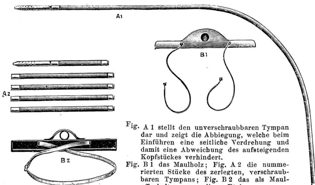
Fig. A 1 stellt den unverschraubbaren Tympan dar und zeigt die Abbiegung, welche beim Einführen eine seitliche Verdrehung und damit eine Abweichung des aufsteigenden Kopfstückes verhindert.
