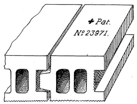
Zu Fig. 2. Hohlsteine zur Excelsior-Massivdecke.
