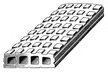
Fig..4. Hohlplatte für Bodenbelag.
