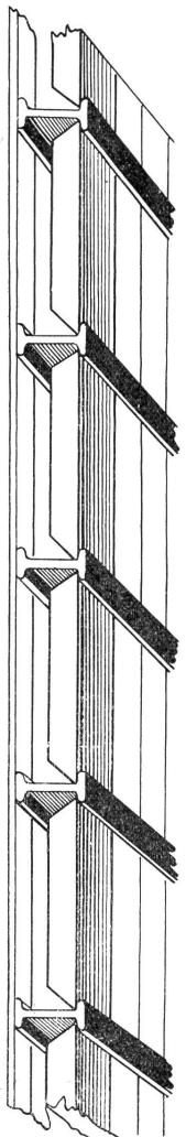
Verwendung mit Widerlagersteinen. (Es werden 10 cm kürzere Hourdis verwendet als die Spannweite der T-Balken beträgt.)
