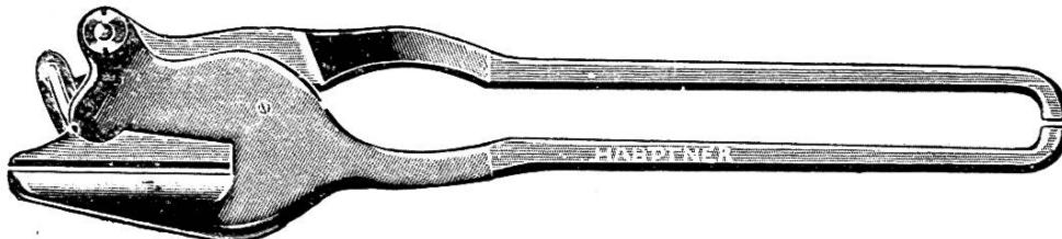
No. 10485. **Kastrierzange** nach Even Paris. — Dient zur Kastration, ohne Eröffnung des Hodensackes, durch starke Quetschung des Samenstranges. Die Quetschung ist eine parallele und auf der ganzen Länge des Maules vollkommen gleichmässig. Das Instrument wird mit grossem Vorteil verwendet bei allen Wiederkäuern, hauptsächlich bei jungen Tieren bis zu einem Jahr. Auch bei älteren Tieren ist es verwendbar, doch wird dann ein vollständiges Verschwinden der Testikel nicht mehr erreicht. Fr. 120.—
