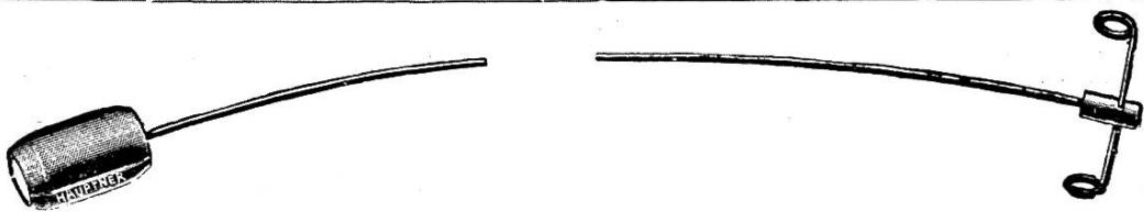
No. 11348. **Lungenschleimfänger** nach Graae & Tallgren, modif. v. Rautmann. Becher unlösbar am Stilet, ein 14 cm. langer Knebel sichert das Instrument vor dem Verschlucktwerden. Desinfektion geschieht durch Füllung des Bechers mit Spiritus und Ausglühen über einer Flamme.
