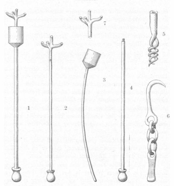
No. 1. Krücke mit Schlauch und Trichter. No. 2. Krücke, 1 m Länge, 1 cm Dicke; gerade Entfernung der Queräste der Krücke 4 cm.
