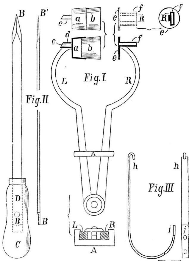
ende (Fig. I, *R*) befindet sich eine Führung (Fig. I, *f*) mit einer Kompress-Scheibe oder Klemmplatte (Fig. I, *e*). In die Führung passt genau eine Stahlnadel (Fig. II) mit einem beidseitig scharf messerförmig zugeschliffenen vorderen Ende (Fig. II, *B'*) und einem stumpfen, staffelförmigen, mit einem Oehr versehenen, hinteren Ende (Fig. II, *B*). Die Nadel ist circa 16 cm lang, 9 mm breit und 2 mm dick und passt in einen Handgriff oder Heft (Fig. II, *C*).
