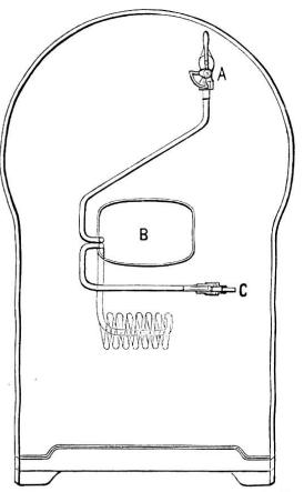
A Contredampfhahn, B Thüre des Herdes, C Verbindung mit der gegliederten Röhre. sechs spaltförmige 1/2 Millimeter hohe Oeffnungen zum Aus-
