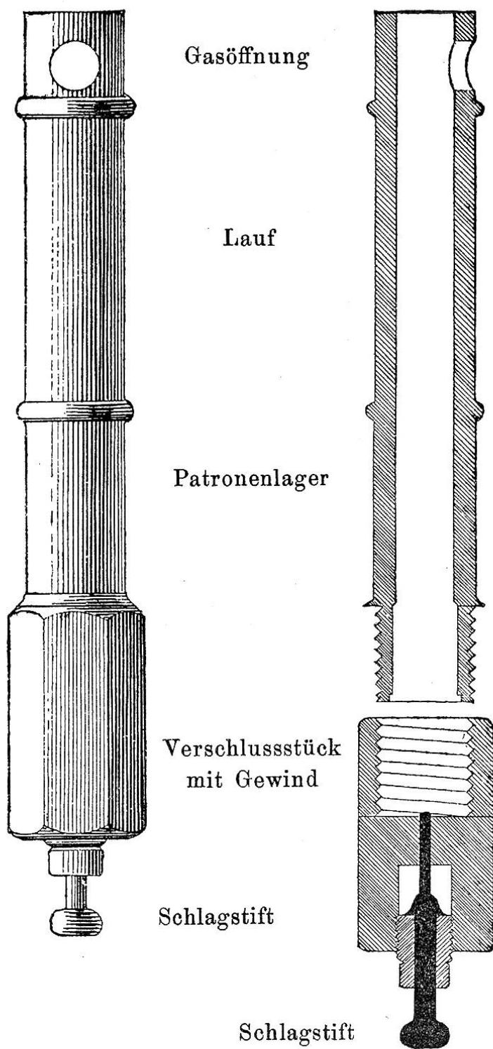
Der Apparat besteht aus dem Lauf, an dessen einem Ende eine seitliche Oeffnung von gleicher Grösse wie das Kaliber, zum Entweichen der Gase angebracht ist. Am andern Ende findet sich das Patronenlager und ein grobes Gewinde zum Anschrauben des Verschlussstückes mit dem Schlagstift.
