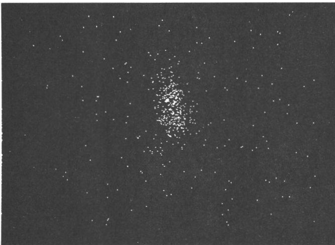
Fig. 4. Analyse sélective à la micro-sonde: A: traces du silicium; B: traces du magnésium.
