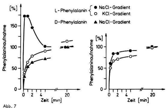
proximalen Tubulus auch bei Umkehr des Natriumgradienten über die Bürstensaummembran noch 50 % der maximalen L-Phenylalaninresorption gemessen werden können (42). Der Transport wird also unter diesen Bedingungen nur von der elektrischen Potentialdifferenz aufrechterhalten.
