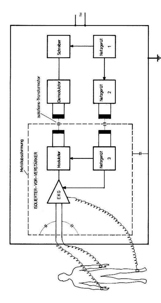
Abb. 8. Blockdiagramm einer vollisolierten Verstärkereingangsstufe von EKG-Geräten.
