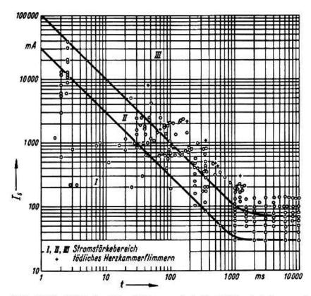
Abb. 2. Die tödlich wirkende Stromstärke in Abhängigkeit von der Einwirkdauer. I, II, III = Stromstärkebereiche, + = tödliches Herzkammerflimmern,  $I_s$  = Stromstärke (Scheitelwert), t = Zeit (Einwirkungsdauer).
