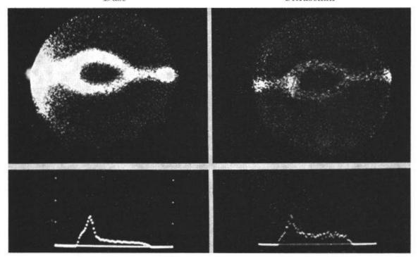
Abb. 6. Aerosoldeposition in einem Glasstück, Strömungsrichtung von links nach rechts.
