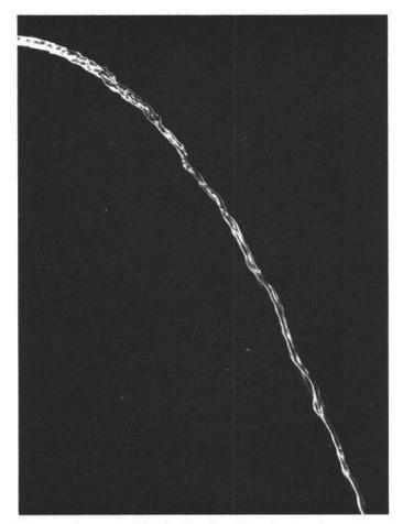
Fig. 2. Jet turbulent photographié à l'aide d'un flash électronique, Re  $=\,2300$ .
