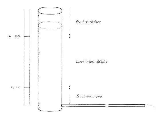
Fig. 1. Dispositif expérimental servant à mettre en évidence les différentes formes d'écoulement.
