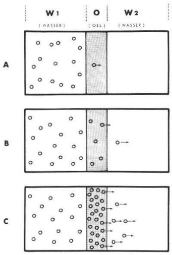
Abb. 2. Passive Diffusion durch eine Ölmembran.
