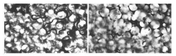
Abb. 3. Mikrostruktur des Anmischungszustandes eines Metakrylatkunststoffes, bestehend aus polymeren Körnern und monomerer Flüssigkeit. Diese ist zwischen den Körnern sichtbar. In Abb. 4 ist die Warmpolymerisation dieser Mischung aufgezeigt. Vergrößerung 75fach.
