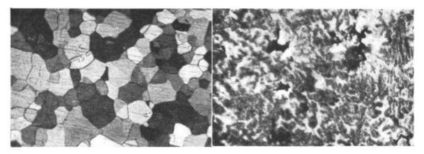
Abb. 1. Homogene Kristallstruktur einer 18 karätigen Goldlegierung mit 5% Platinzusatz. In diesem Zustand ist die Legierung korrosionsfest. Als Vergleich der inhomogene Zustand von Abb. 2. Vergrößerung 100fach.
