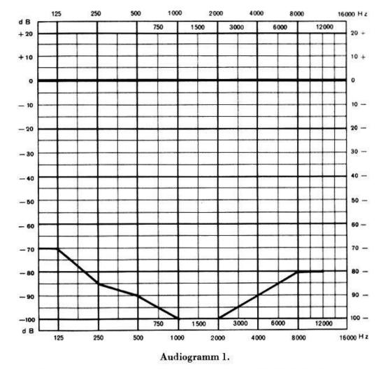
Modell, das zeigt, bis zu welchen Intensitäten mit dem Beoton-Apparat geprüft werden kann.
