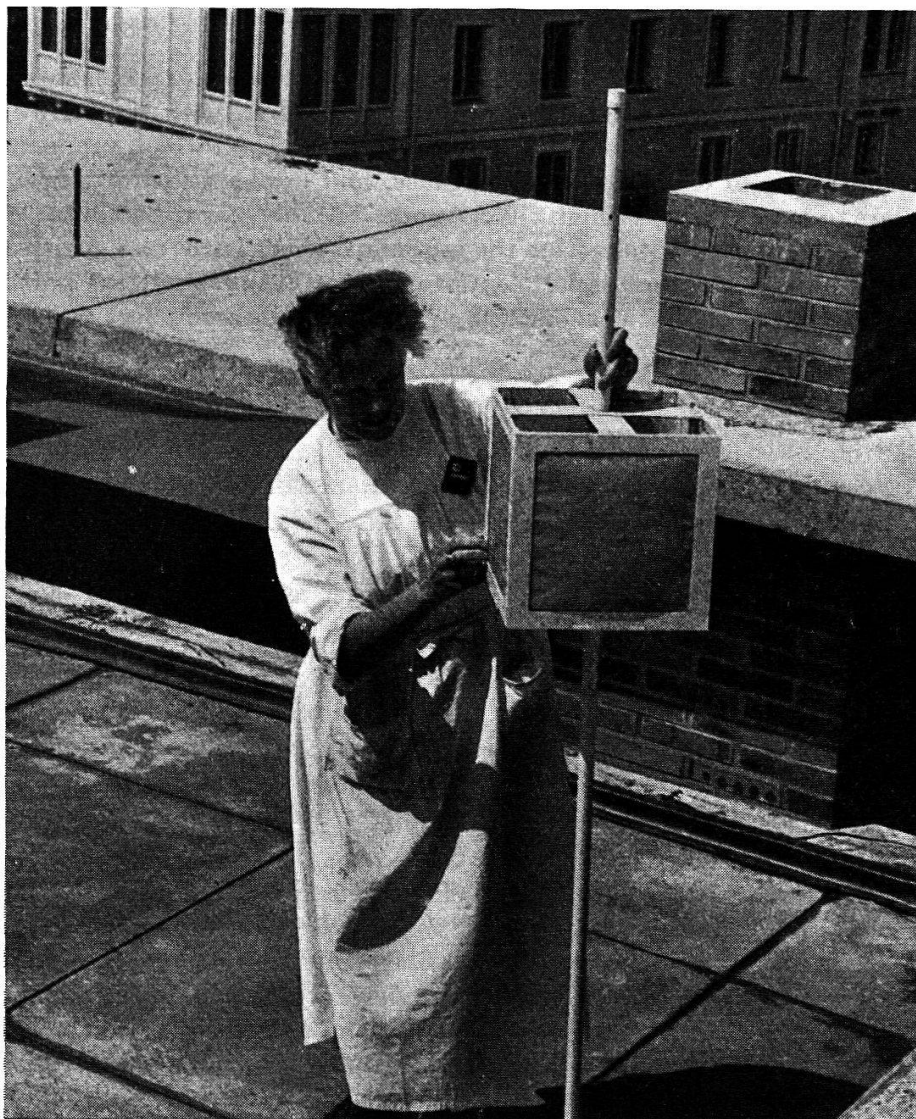
Abb. 1. Vertikal nach den vier Haupthimmelsrichtungen exponierte Staubfangfolien.
