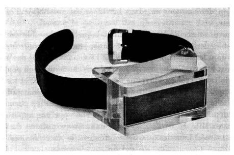
Fig. 1. Montre-bracelet fictive, en plexiglas, portant une charge de 100  $\mu \rm C$  de radium.
