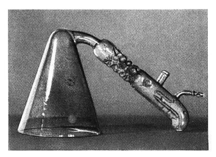
Fig. 1. Séparateur de germes. Il s'agit d'un appareil producteur d'aérosol muni d'un entonnoir.
