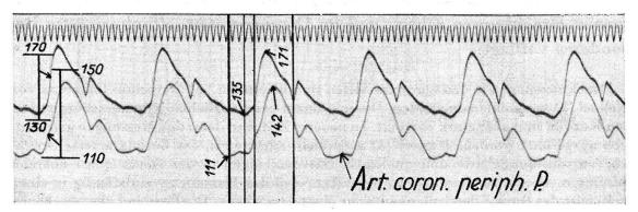
Abb. 3. Obere Kurve: Druckkurve in der Aorta ascendens, 1,5 cm distal vom CaU. Untere Kurve: Druckkurve im Ramus descendens anterior, 10,2 cm distal vom CaU.
