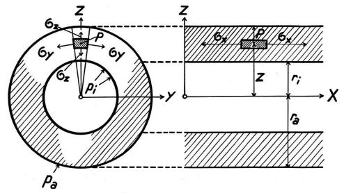
Abb. 1. Begrenzter Hohlzylinder im Längs- und Querschnitt.
