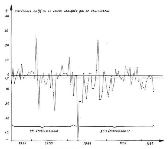
Fig. 2. Contrôles de l'activité absolue d'envois de phosphore-32.
