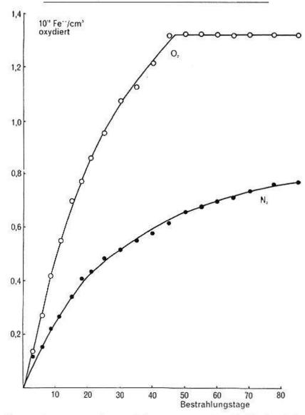
Abb. 1. Strahlenoxydation von n/500 FeSO<sub>4</sub>-Lösung in 0,8 n  $\rm H_2SO_4$  durch die Gesamtstrahlung von Rb<sup>86</sup>. Obere Kurve: O<sub>2</sub>-Sättigung der Lösung; untere Kurve: N<sub>2</sub>-Sättigung.
