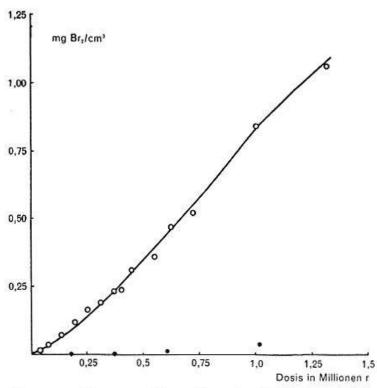
Abb. 2. Abspaltung von Brom aus Bromoform durch Röntgenstrahlen in wasserfreier Substanz. Punkte über der Abszissenachse: Bestrahlung in festem Zustand.
