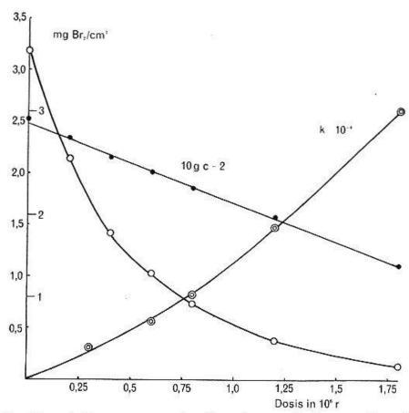
Abb. 3. Strahlenreaktion von wässeriger Bromlösung. Ordinate rechts: Abfall der Bromkonzentration (Kreise) mit steigender Strahlendosis und Logarithmus dieses Abfalls (volle Kreise); Ordinate links: Zunahme der spezifischen Leitfähigkeit der bestrahlten Lösung k in 10<sup>-4</sup> Ohm<sup>-1</sup>cm<sup>-1</sup>.
