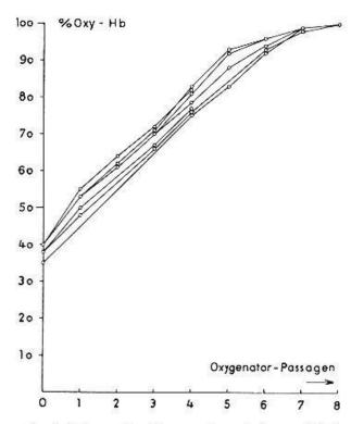
Abb. 6. Bestimmung der Leistung des Oxygenators bei verschiedenen Pumpenleistungen zwischen 500 und 1500 ml/min: 200 ml venöses Katzenblut, entsprechend einem Hb.-Gehalt von 16 g/100 ml (nach Sahli) wurden über den Oxygenator gepumpt. Nach einer oder mehreren Passagen wurde die Zunahme der Sauerstoffsättigung gemessen. Auf der Abszisse ist die Anzahl der Passagen, auf der Ordinate die Sauerstoffsättigung des Hb. aufgetragen. Berechnung der Leistung im Text (s. S. 485)<sup>4</sup>.
