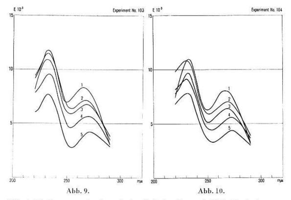
Abb. 9. Die Zerstörung des Aneurins in alkalischer Lösung (pH 9). Die Änderungen der Vitamin- $B_1$ -Konzentration ( $\gamma/20~\rm cm^3$ ) in der Versuchslösung im Lauf des Versuches: 1. Beginn: 97  $\gamma$ , 2. 24 Std.: 55  $\gamma$ , 3. 48 Std.: 35  $\gamma$ , 4. 72 Std.: 25  $\gamma$ , 5. 144 Std.: 8  $\gamma$ . Die Spektra wurden bei pH 9 aufgenommen.
