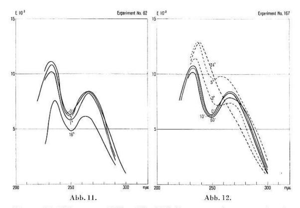
Abb. 11. Die Wirkung von KEE auf das U.V.-Absorptionsspektrum von Aneurin. Ablauf des Versuches und die Vitamin- $B_1$ -Konzentrationen in 20 cm³ Versuchslösung: 0 Min.: 100  $\gamma$ , 1 Min.: Zugabe von 0,5 cm³ KEE, 5 Min.: 10  $\gamma$ , 1 Std.: 8  $\gamma$ , 16 Std.: 5  $\gamma$ .
