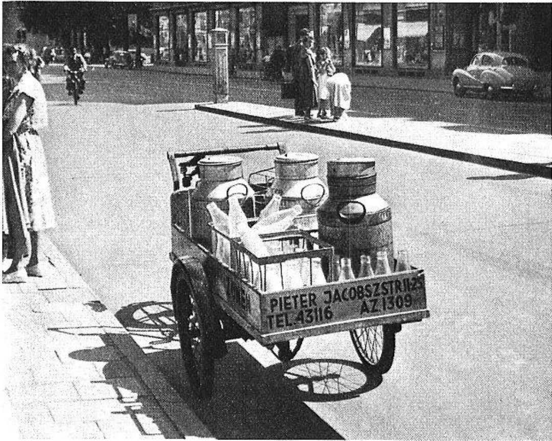
Abb. 2. Ungenügender Milchwagen, auf dem die Milch dem Sonnenlicht ausgesetzt ist. (Photo G. Massy.)
