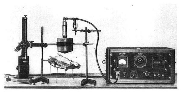
Abb. 1. Versuchsanordnung zur Bestimmung von J<sup>131</sup> in der Thyreoidea der lebenden Ratte.
