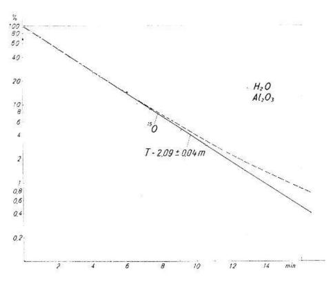
Fig. 3. Décroissance de l'activité de l'oxygène irradié sous forme de H<sub>2</sub>O ou de Al<sub>2</sub>O<sub>3</sub>.
