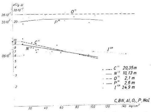
Fig. 12. Détermination absolue avec extrapolation à zéro des poudres actives de C, BN, Al<sub>2</sub>O<sub>3</sub>, P et NaI.
