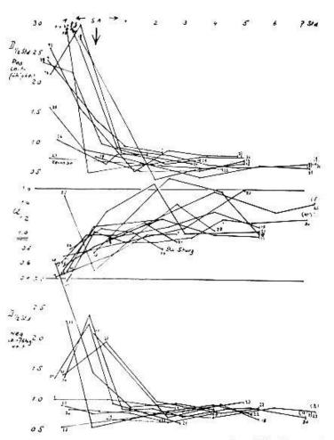
Abb. 1. Wechsel der atmosphärischen Leitfähigkeit mit dem Sonnenaufgang. D = Entladung des Elektrometers durch negative (a<sup>-</sup>) resp. positive (a<sup>+</sup>) Ionen.
