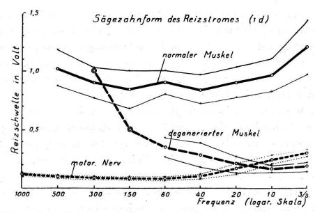
Abb. 3. Abhängigkeit der Reizschwellen von der Frequenz. Die Stromimpulse haben die Sägezahnform von Abb. 1 d. Fette Linien = Mittelwerte. Die dünnen Linien entsprechen  $\pm \varepsilon$  des Mittelwertes.
