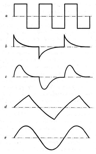
Abb. 1. Die hauptsächlich verwendeten Stromformen.
