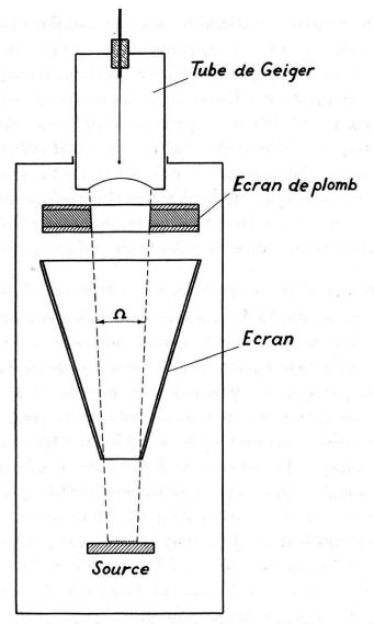
Fig. 6. Schéma de principe du dosage absolu des isotopes (G. Joyet et G. Nassibian).
