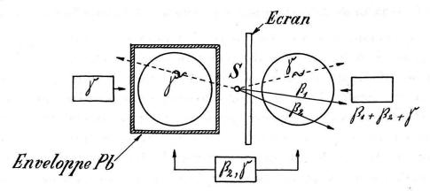
Fig. 4. Tubes compteurs montés en coı̈ncidence pour déterminer le schéma de désintégration d'un isotope à émission  $\alpha$ ,  $\beta$  et  $\gamma$ .
