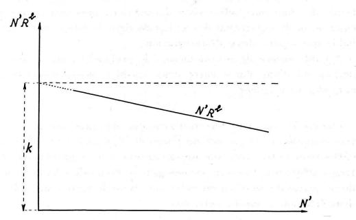
Fig. 8. Etalonnage graphique de la perte d'impulsions statistiques par la méthode du carré de la distance.
