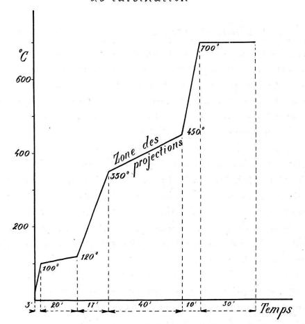
Fig. 15. Schéma normalisé de calcination.
