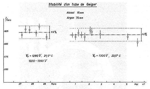
Fig. 7. Stabilité d'un tube de Geiger au cours du temps.
