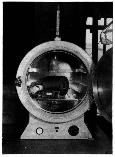
Fig. 6. Dispositif à nacelles logé dans un thermostat.
