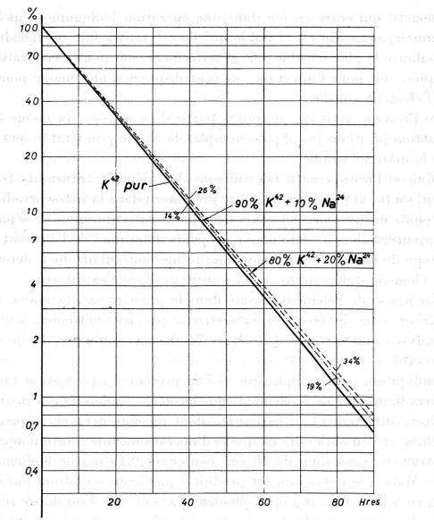
Fig. 19. Courbes de décroissance de \*K42 pur ou additionné de 10 et 20% de \*Na24.
