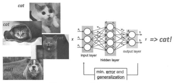
Figure 2: un réseau (simplifié) de neurones artificiels est entraîné afin de reconnaître des chats sur des images.
