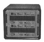
Durch entsprechende Detektion eines Verbindungsaufbaues wird die anschliessende Störung durch kurzzeitige Emission eines Störsignales durchgeführt.
