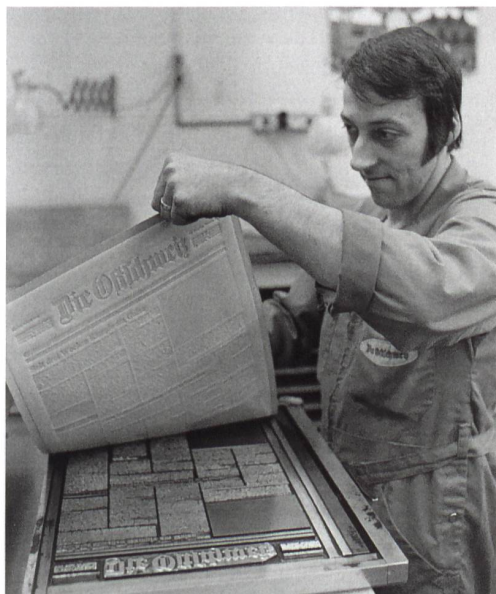
Als Zeitungsmachen in erster Linie noch Handwerk war: Ab einem sogenannten Schiff mit der in Blei gesetzten Titelseite der «Ostschweiz» wird eine Matrice gezogen, die dann als Vorlage zur Herstellung der Druckplatte dient. (Bild: Stadtarchiv St. Gallen)
