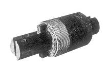
um eine 30 cm lange Achse zu drehen, wobei sich der Zylinder wegen des Schraubengewindes millimeterweise an der Achse von einer Seite auf die andere verschob. Auf dem Zylinder sah man Rillen im Abstand von 2,5 mm eingeritzt, ferner zwei kleine Trichter, die Krüsi mit Stiften befestigt hatte, ein Mundstück zum Sprechen und eine Membrane zur Wiedergabe.
