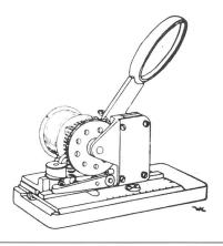
Büroheftmaschine mit Drahtspule und selbsttätiger Klammerbildung von Viktor Kobler (1858–1937).
